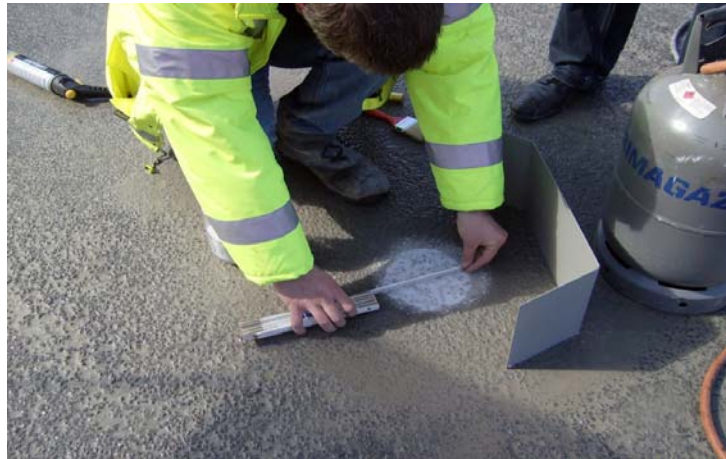
Foto 1: Monitoren van de textuur diepte
