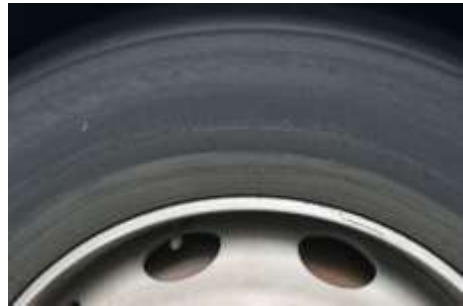
Schade aan wang van rechterband
