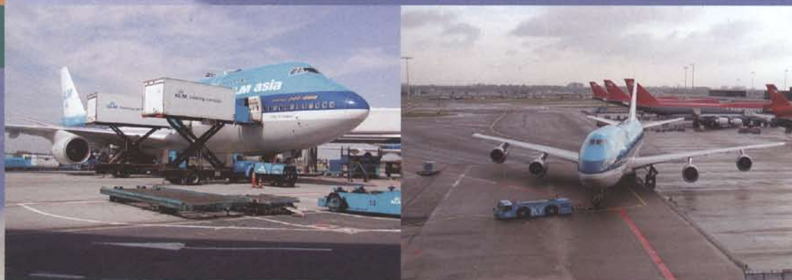
Vliegtuig met cateringauto, container op schaar, auto op steunstempels / Vliegtuig met trekker
