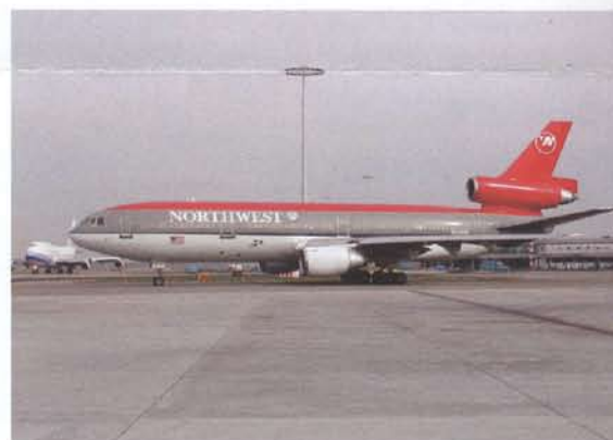
Stilstaand vliegtuig: zeer hoge wiellasten!
